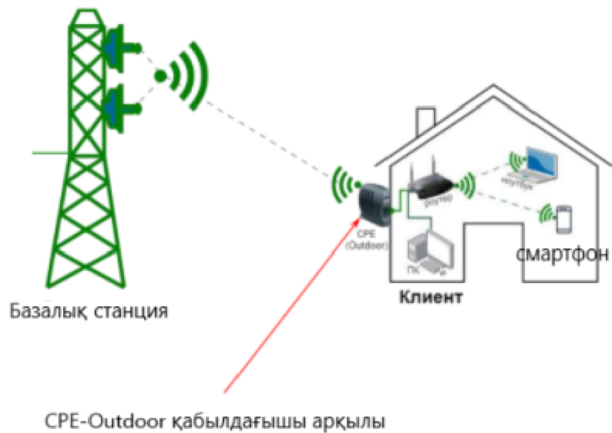
2.5-сурет – Базалық станциядан CPE-Outdoor құрылғысы арқылы үйге сымсыз интернет тарату схемасы
