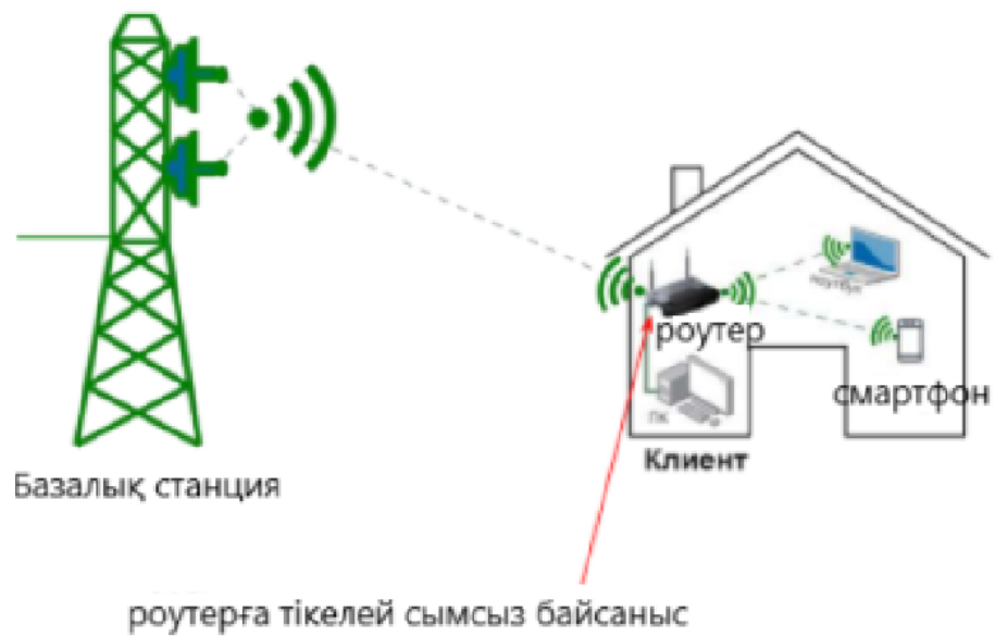
2.4-сурет – Тұрғын үй ішіндегі (Indoor) FWA байланыс схемасы
